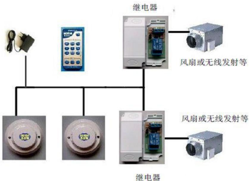
多个探测器、多个报警器可以组网运行，最远连接距离可达 1000 米。
