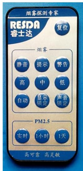
就可以显示报警、语音播放。操作成功时红灯闪一下,表示此灵敏度工作在自动模式,黄灯闪一下表示工作做在显示锁定模式,蓝灯闪一下工作在声音锁定模式。
